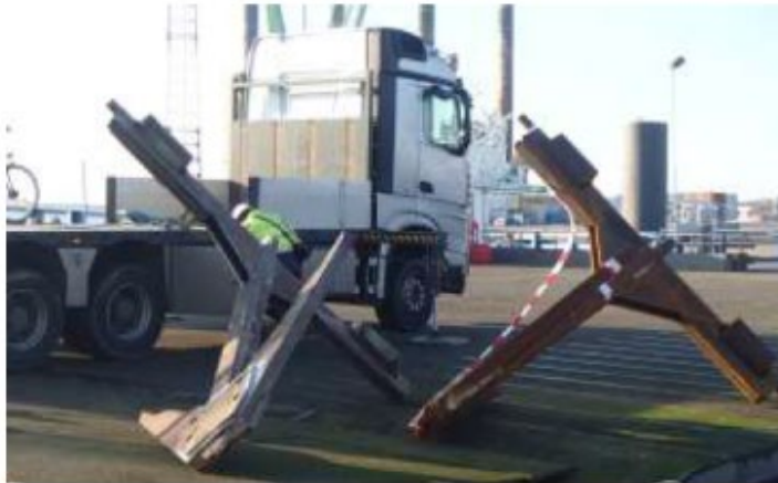
Figuur 4-3: Voorbeeld van een grapnel
