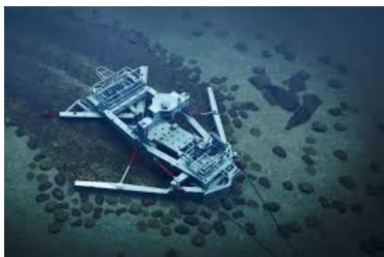
Figuur 4-2: Voorbeeld van een ploeg
