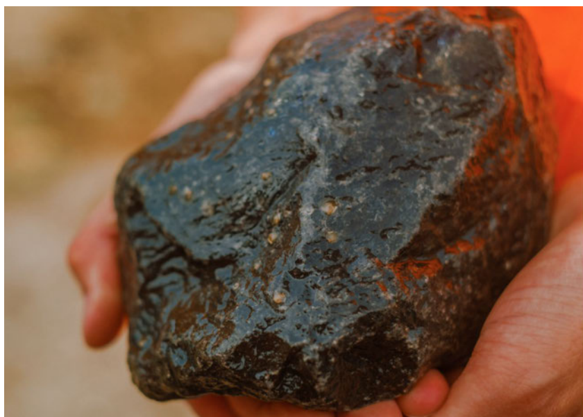
Figuur 4-25 Voorbeeld van stortsteen waarop zich oesterlarven hebben gehecht
