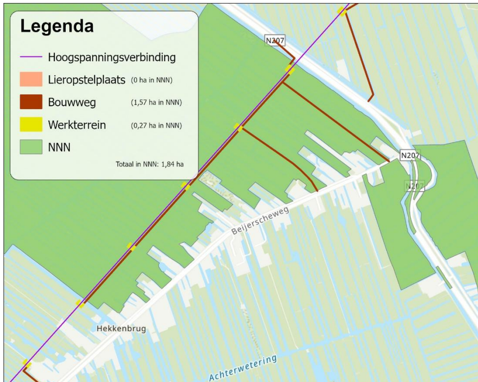
Figuur 7-6: Overzicht van de mastlocaties, lierlocaties, bouwwegen en werkterreinen gelegen in het NNN ter hoogte van Polder het Beijersche. Het betreft de mastlocaties KIJ-DIM380 030 t/m KIJ-DIM380 033.
