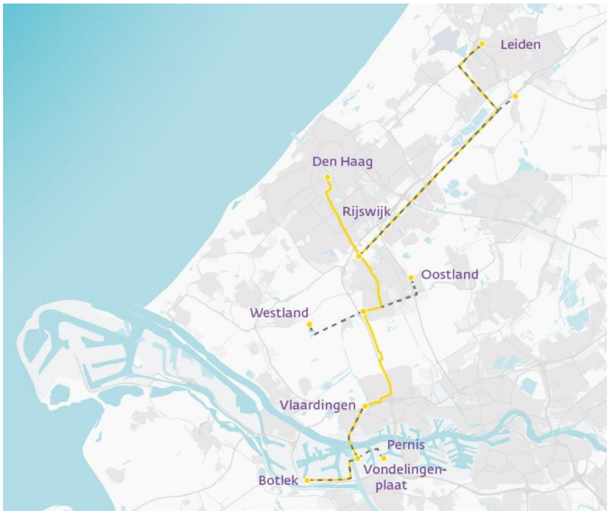
Figuur 19-1 WarmtelinQ transportleiding restwarmte uit het Rotterdamse havencomplex (bron: WarmtelinQ)
