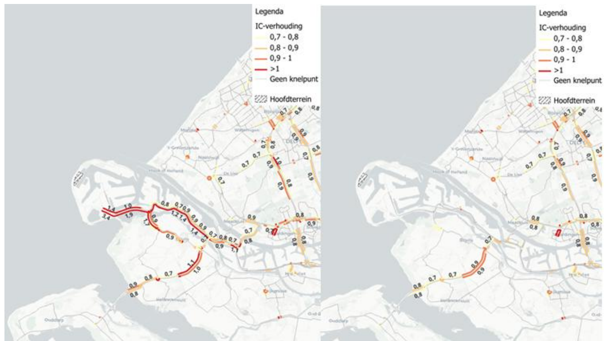
Figuur 7-16 Links: I/C-analyse bouwphase Maasvlakte II, rechts: I/C-analyse bedrijfsfase Maasvlakte II
